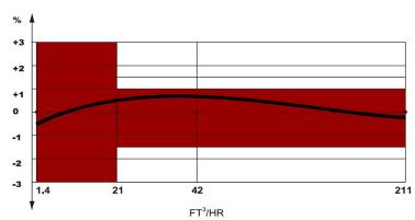
Diaphragm Gas Meter 211 CFH
